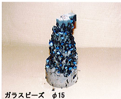
写真-1 ポーラスコンクリートモデル供試体の圧縮破壊性状
