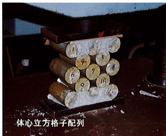
写真-2 モデル供試体の圧縮破壊試験
